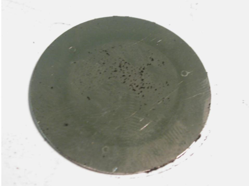
**Figure 0.21 Smoke Alarm Horn Disc.**
